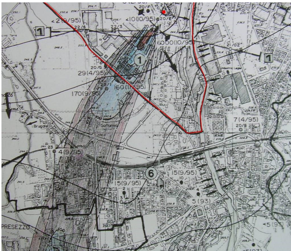
Figura 29 Plume di contaminazione della falda acquifera e indicazione del punto presunto di contaminazione (in rosso)
