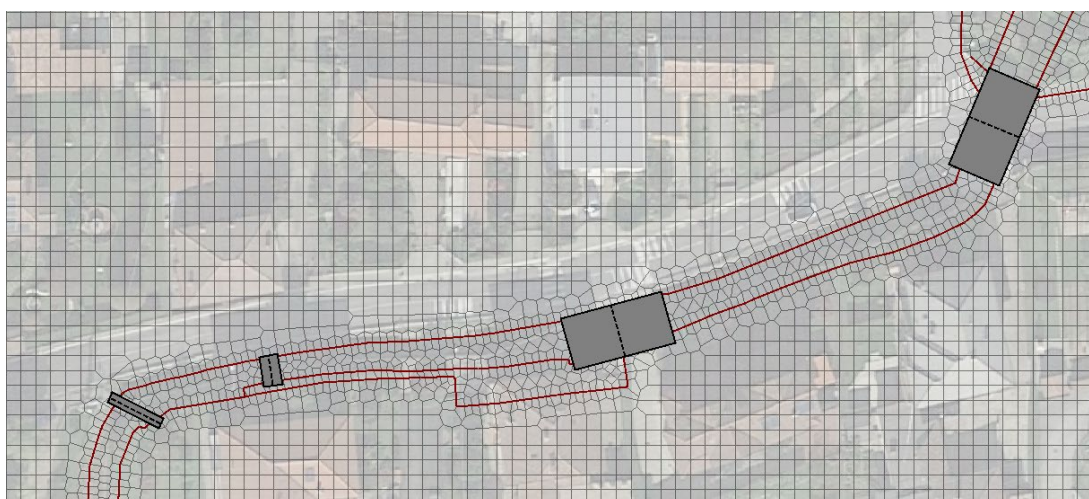
Figura 20: Estratto della mesh di calcolo in via IV Novembre (le barre grigie rappresentano i ponti).
